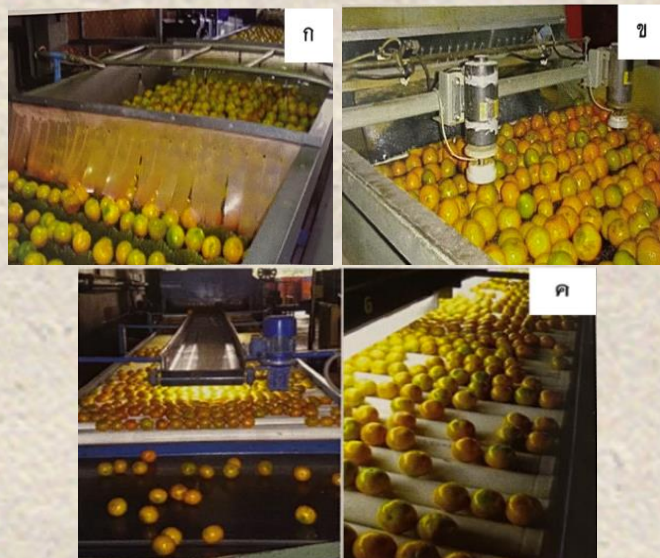
ภาพที่ 3.4 การใช้ฟองน้ำดูดซับน้ำให้แห้งก่อนเคลือบ (ก) การเคลือบผิวผลส้ม (ข) และการอบลมร้อนให้ ผิวผลส้มแห้ง (ค)
