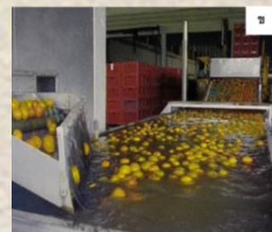
ภาพที่ 3.2 การล้างผลส้มโดยการฉีดพ่นน้ำ (ก) และการแช่น้ำ (ข)
