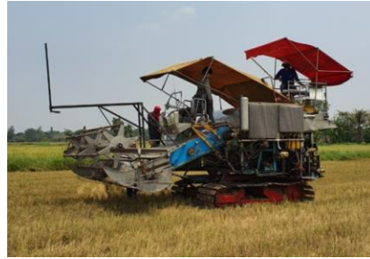
ภาพที่ 25.2 รถเกี่ยวข้าวที่ติดตั้งระบบชุดหัวเกี่ยวแบบอัตโนมัติ ที่มา: กิตติพงษ์ และคณะ (2560)
