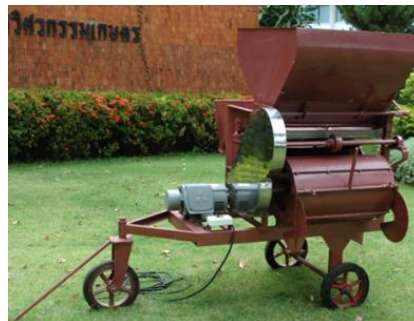
ภาพที่ 25.4 ดันแบบเครื่องทำความสะอาดเมล็ดพันธุ์ข้าวเปลือก
