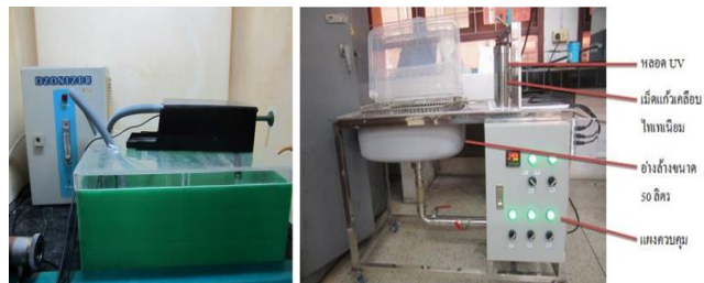
ภาพที่ 23.7 อ่างล้างผัก (ก) และเครื่องล้างผัก (ข) ระบบหมุนเวียนน้ำ โดยใช้ \text{TiO}_2 ที่เคลือบบนเม็ดแก้ว (glass beads) ร่วมกับโฟโตแคตตาไลซิส ที่มา: กานดา และสาธิต (2558)
