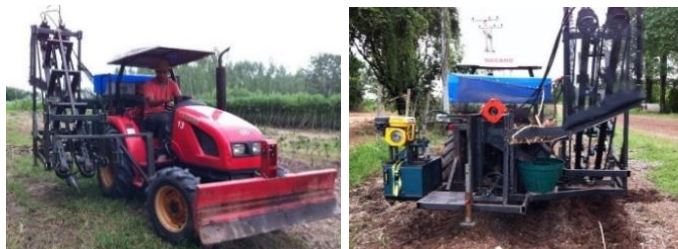
ภาพที่ 28.4 เครื่องเก็บเกี่ยวมันสำปะหลังสำหรับ รถแทรกเตอร์ขนาดเล็ก ที่มา: วีรชัย และคณะ (2556)
