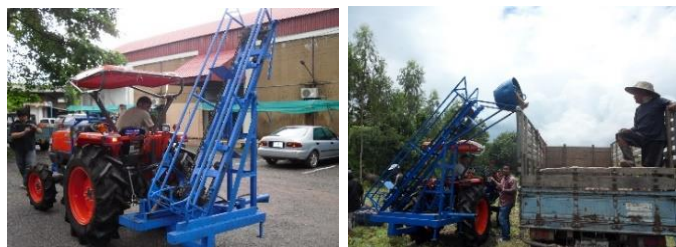
ภาพที่ 28.5 เครื่องลำเลียงมันสำปะหลังขึ้นรถบรรทุก ที่มา: วีรชัย และคณะ (2556)
