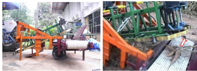
ภาพที่ 28.2 เครื่องเก็บเกี่ยวมันสำปะหลังแบบชุดและรวมกอง ที่มา: เสรี และชัยยันต์ (2554)
