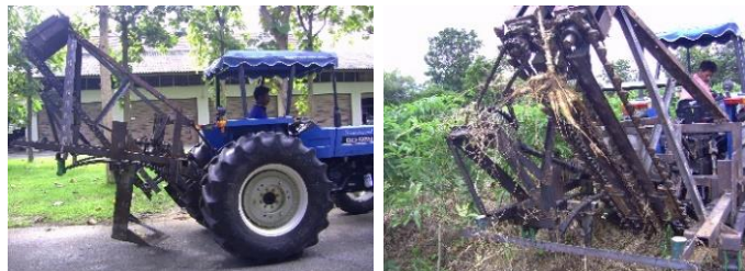
ภาพที่ 28.3 เครื่องเก็บเกี่ยวมันสำปะหลังแบบถอนหัวมันขึ้น ที่มา: วิชา และคณะ (2552)
