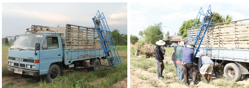
ภาพที่ 8 อุปกรณ์ลำเลียงหัวมันสำปะหลังติดตั้งกับรถบรรทุก
