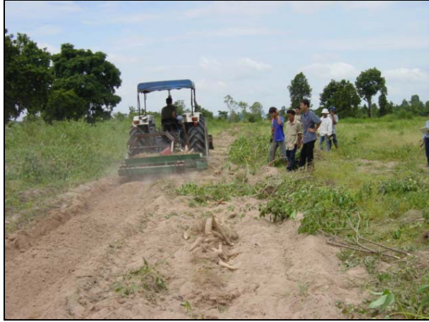
รูปที่ 2.3 เครื่องขุดมันสำปะหลังของศุภวัฒน์ ปากเมข (2540) ซึ่งสมนึก ชูศิลป์ และเสรี วงศ์พิเชษฐ (2545) ปรับปรุงให้สามารถติดตั้งที่ด้านหลังของรถแทรกเตอร์
