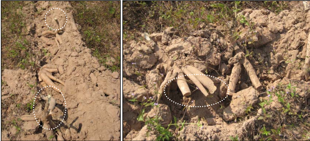
รูปที่ 4.17 สาเหตุของความสูญเสียในการขุด เกิดจากการหักที่ส่วนปลายของหัวมันบางหัว ระหว่างการขุดมันสำปะหลัง ด้วยอุปกรณ์ขุดมันฯ ที่พัฒนาขึ้นมา
