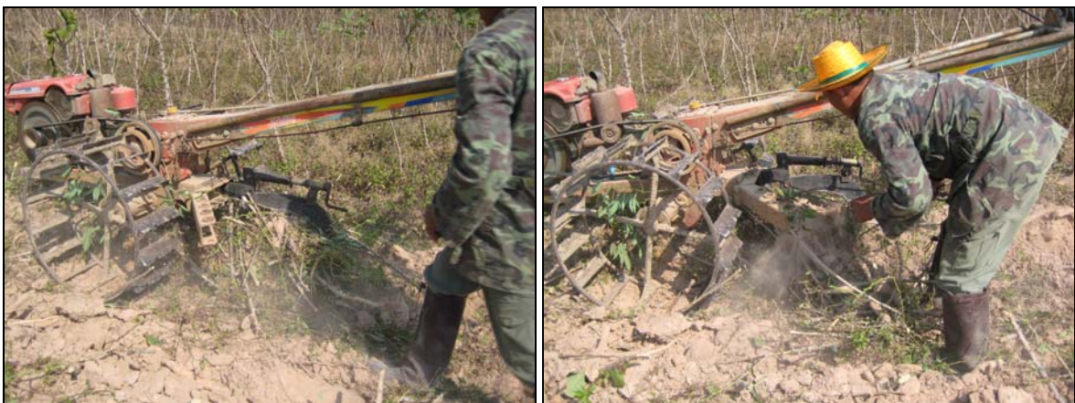
รูปที่ 4.7 ลักษณะที่เหง้ามันภายหลังการขุด มักเคลื่อนที่มาขัดติดที่โครงของอุปกรณ์ขุด (ซ้าย) ต้องหยุดดึงเหง้ามันออกจากโครงฯ จึงจะเคลื่อนที่ต่อไปได้ (ขวา)
