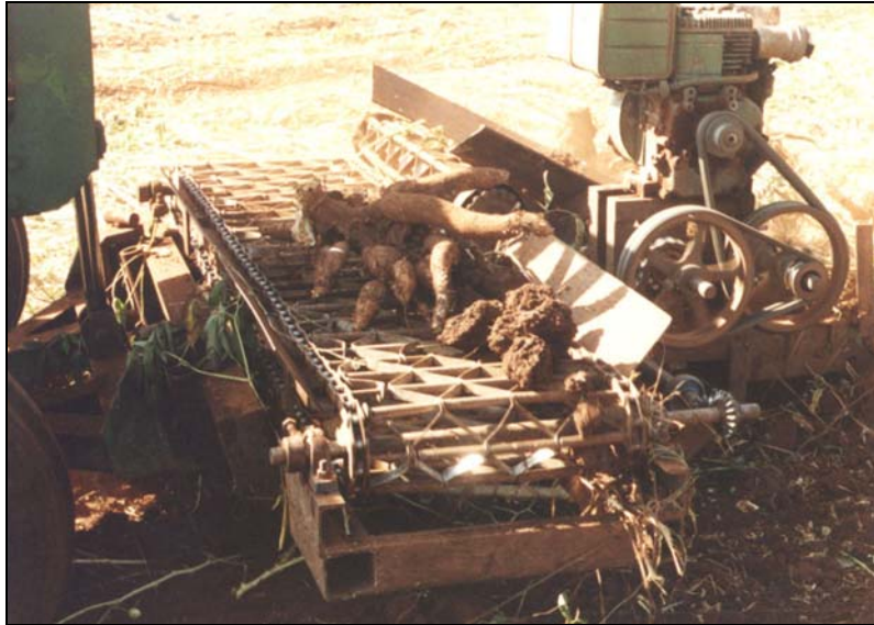
รูปที่ 2.1 เครื่องขุดมันสำปะหลัง ที่มีฟันขุดรูปสามเหลี่ยม และติดตั้งที่ด้านหน้าของรถแทรกเตอร์
