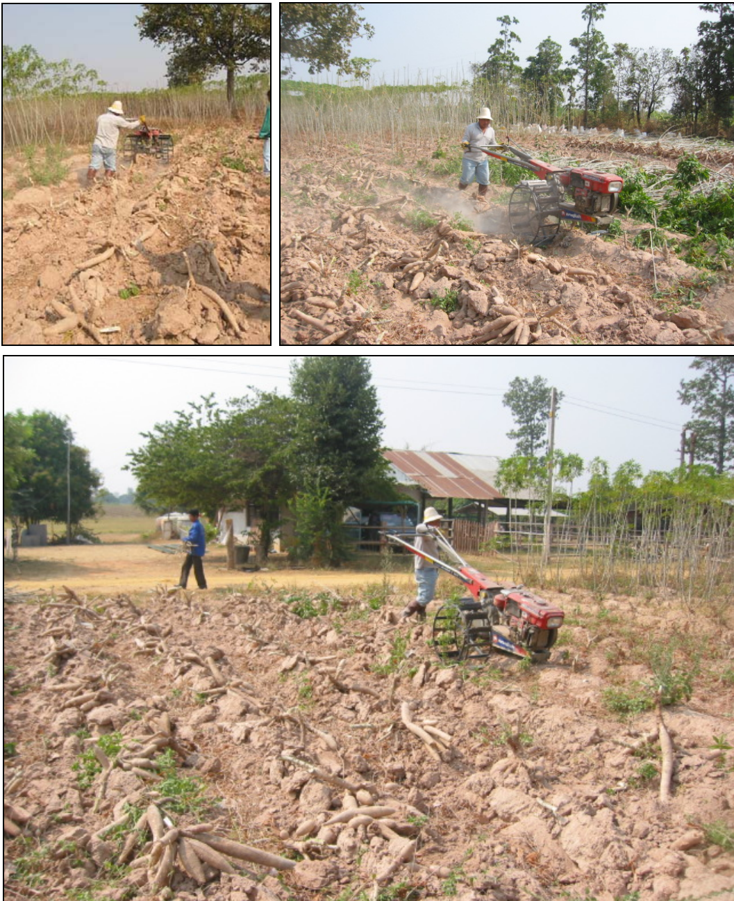
รูปที่ 4.13 ผลการทดสอบการทำงานของอุปกรณ์ขุดมันสำปะหลังที่ออกแบบใหม่
