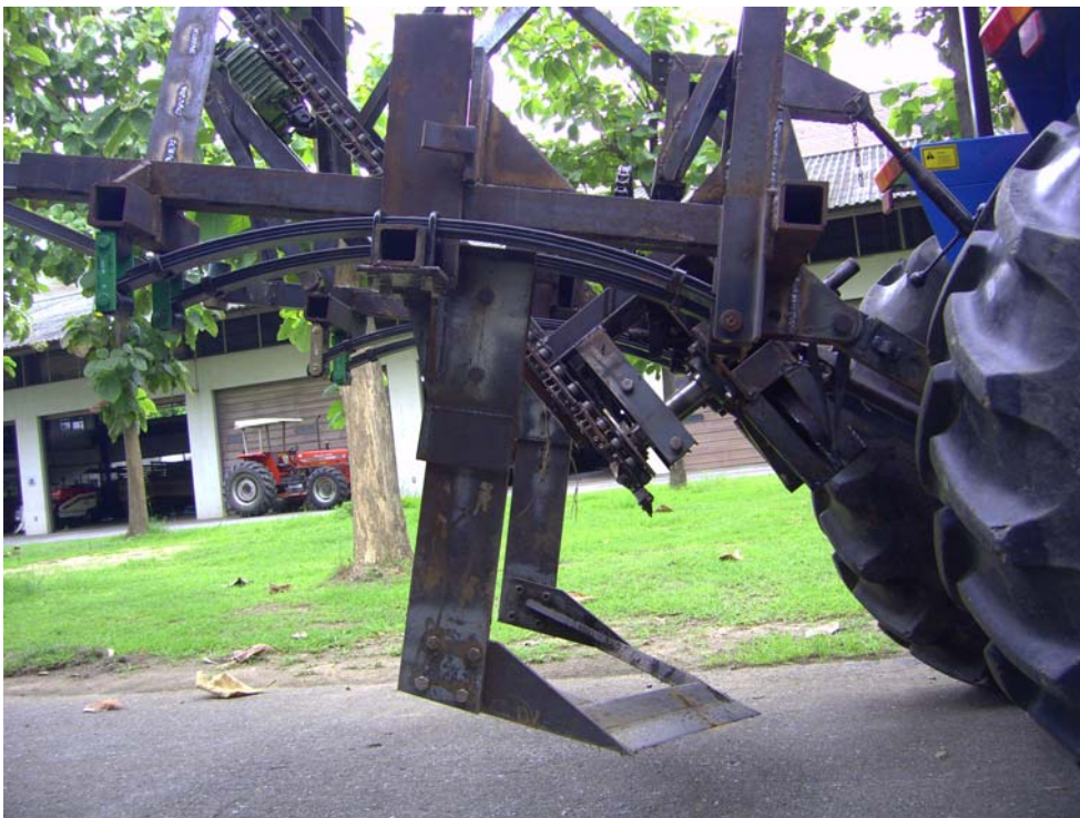
รูปที่ 4.4 หัวชะดินถูกออกแบบให้ติดตั้งอยู่บนแขน 4 คู่ (ข้างละ 2 คู่)
