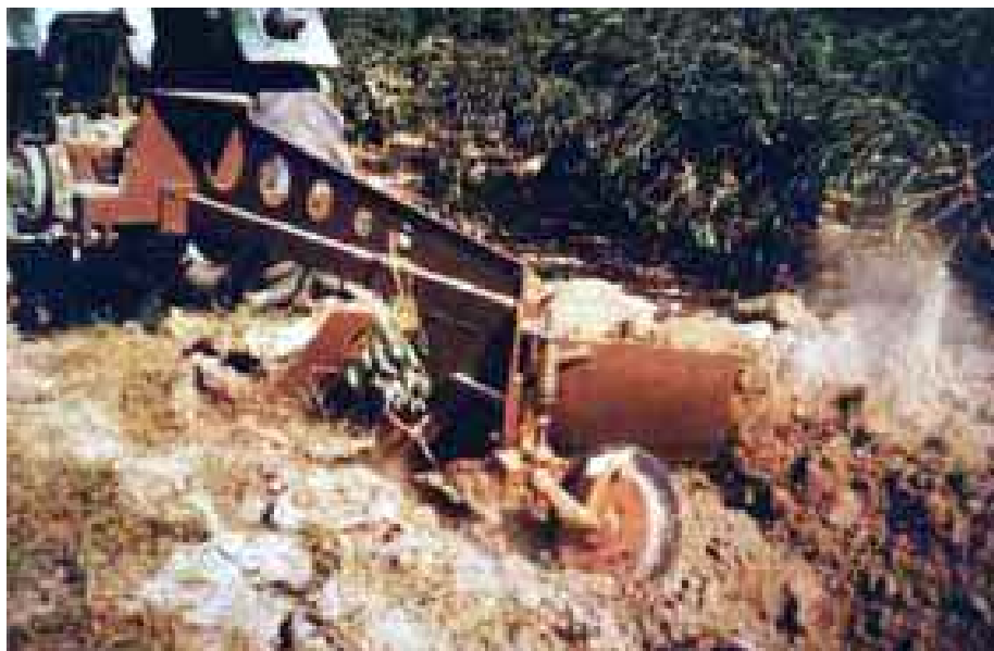
รูปที่ 2.7 เครื่องขุดมันสำปะหลังแบบคันเดี่ยวของ กองเกษตรวิศวกรรม
