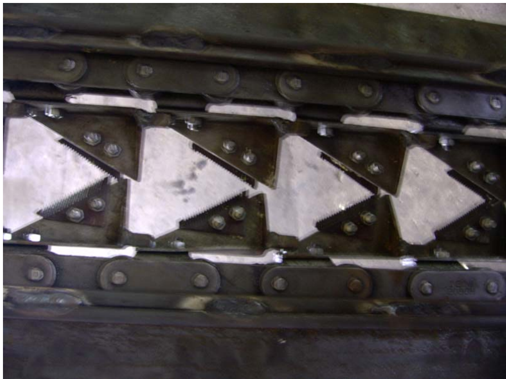
รูปที่ 4.6 ครีบเหล็กสำหรับดึงต้นมันสำปะหลัง ถูกนำมายึดติดกับโซ่ลำเลียง
