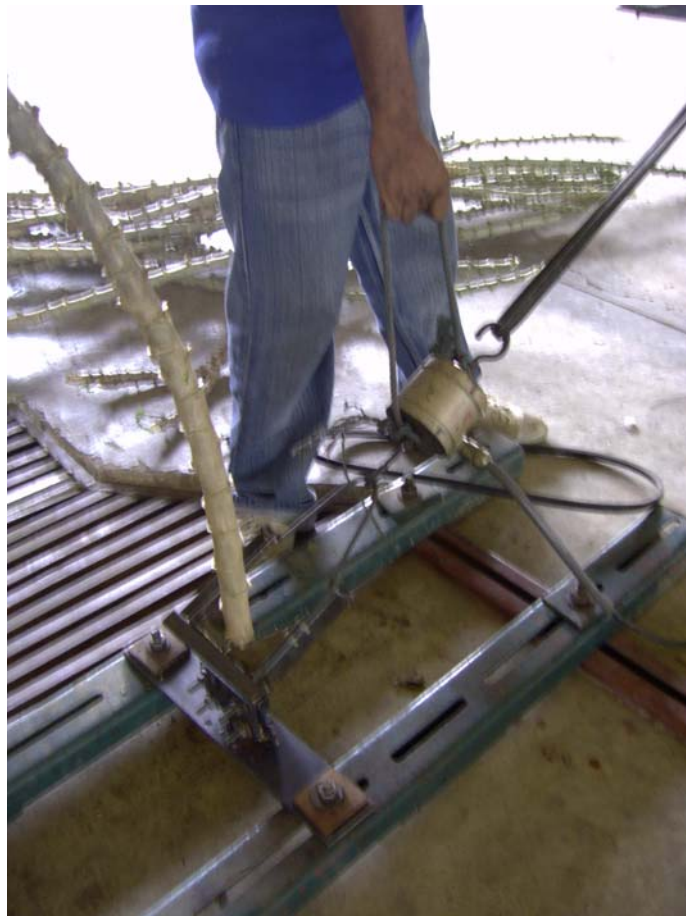
รูปที่ 3.17 ขณะทดสอบการดึงต้นมันสำปะหลัง ณ.ที่ มุมต่างๆ
