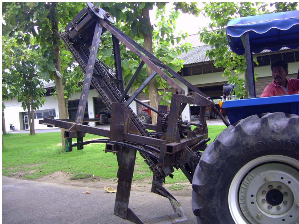
รูปที่ 4.2 การยกหัวชุดขึ้นลงควบคุมโดยไฮดรอลิกส์ของรถแทรกเตอร์
