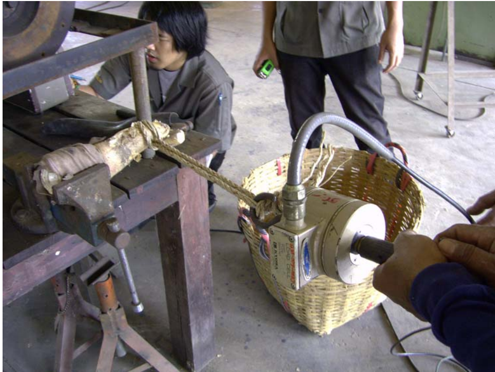
รูปที่ 3.15 ขณะทดสอบความต้านทานแรงดัด (Bending force) ของหัวมันสำปะหลัง
