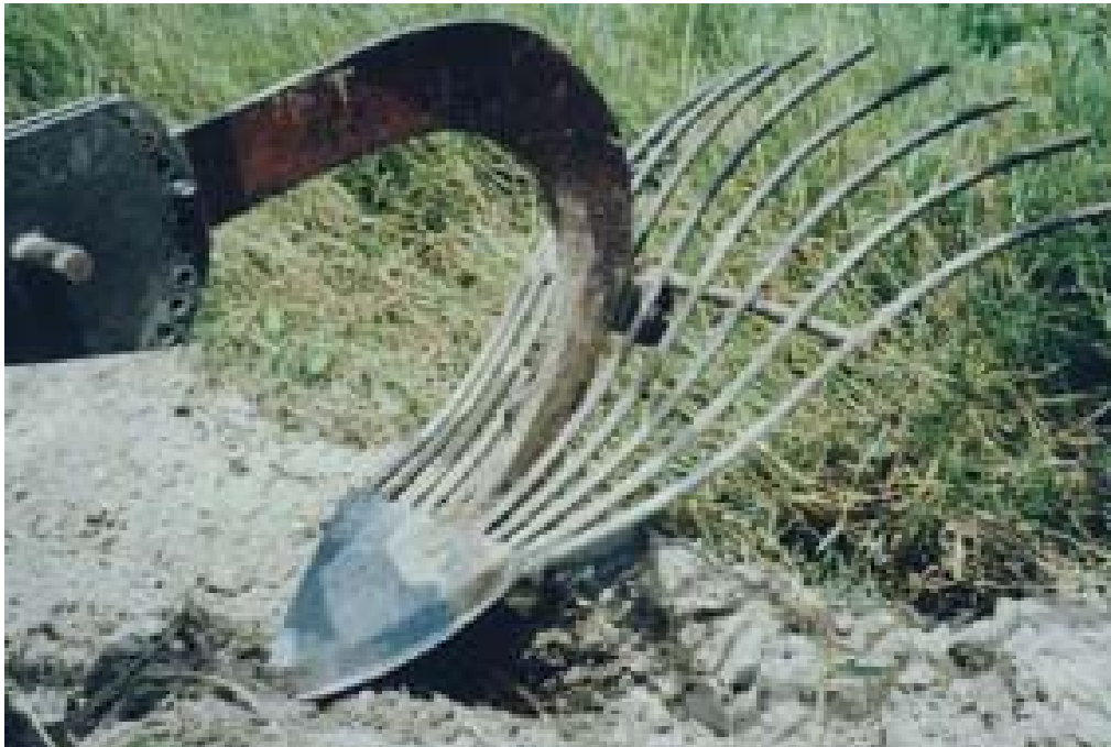
รูปที่ 2.1 เครื่องขุดมันฝรั่งแบบติดรถไถเดินตามพัฒนาโดยกองเกษตรวิศวกรรม
