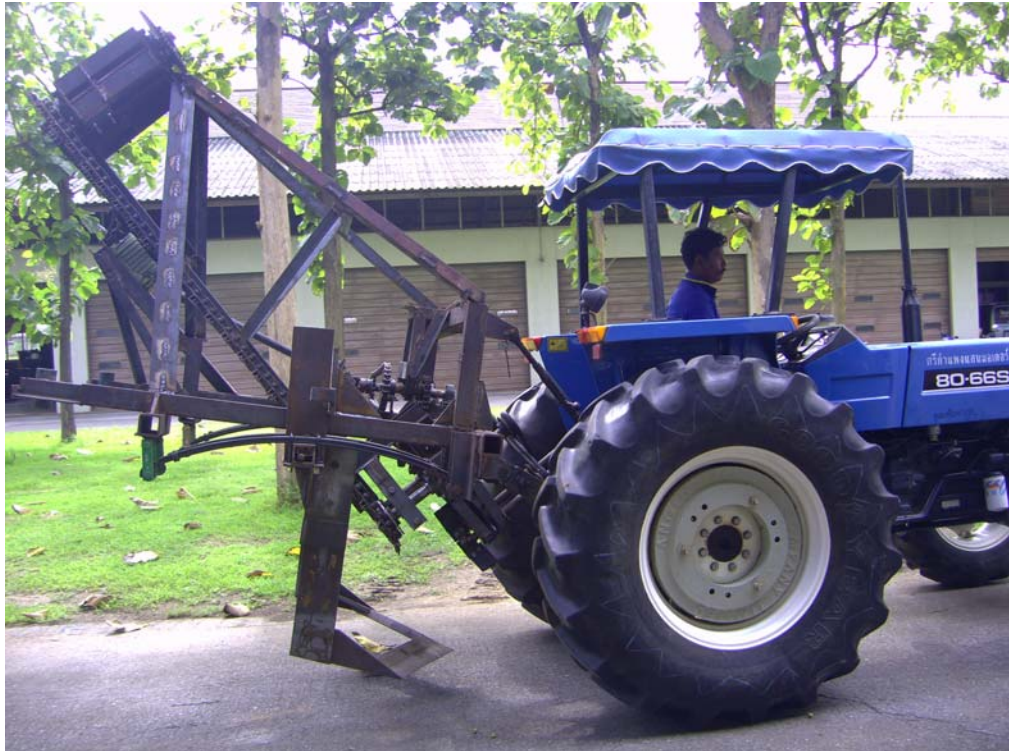
รูปที่ 4.1 เครื่องเก็บเกี่ยวมันสำปะหลังต้นแบบที่ใช้การต่อติดเข้ากับท้ายรถแทรกเตอร์แบบจุดยึด 3 จุด ( Three point hitch )
