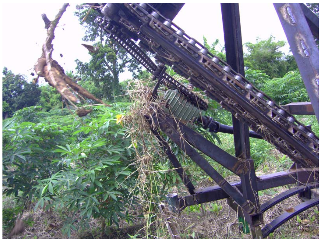
รูปที่ 4.15 ภาพขณะโซ่ลำเลียงกำลังปล่อยก้อนดินสำหรับปลูก
