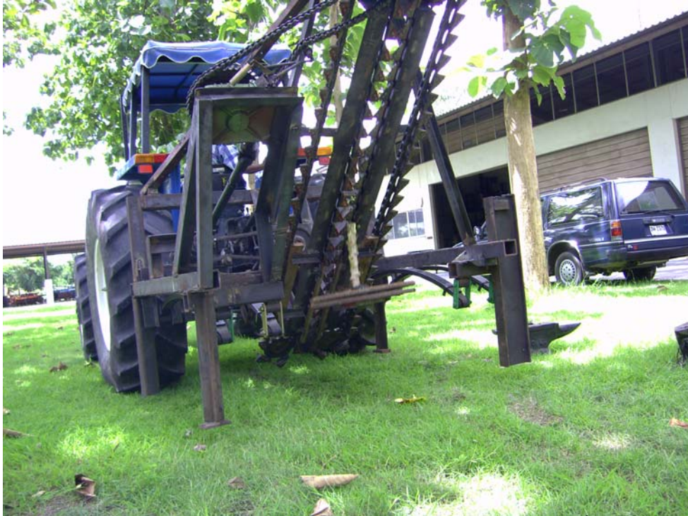
รูปที่ 4.11 การจำลองสถานการณ์ สมมุติว่า ชุดตึงต้น ตึงต้นมันสำปะหลังขึ้นมาแล้วลำเลียงไป ปล่อยออกทางข้างหลังเครื่อง
