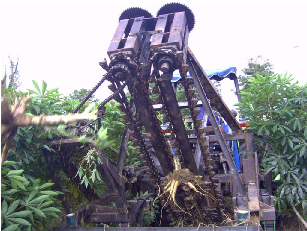
รูปที่ 4.14 ครีบดึงต้นมันสำปะหลังขณะดึงต้นมันสำปะหลังขึ้นมาโดยใช้ลำเลียง
