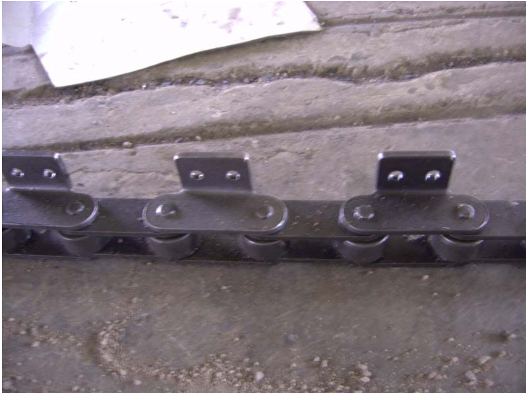
รูปที่ 4.5 ชุดโซ่ลำเลียงที่ใช้สำหรับดึงต้นมันสำปะหลัง เป็นโซ่ แบบ Double pitch chain no. 80 ชนิด Roller ใหญ่ หรือเบอร์ที่เรียกทางการค้า คือ 2080 H
