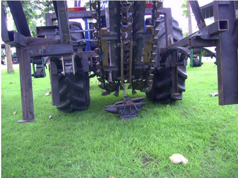
รูปที่ 4.9 การทดสอบแรงดึงสูงสุดของโซ่ลำเลียงที่ครีปดึงต้นมันสำปะหลังสามารถดึงขึ้นมาได้โดยการให้เครื่องเก็บเกี่ยวมันสำปะหลังเคลื่อนที่ผ่าน ทั้งซึ่งมีน้ำหนัก 110 กก.
