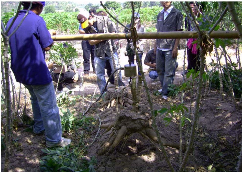
รูปที่ 3.9 ภาพแสดงขณะกำลังทดสอบหาแรงดึงเห้งไม้ลำปะหลังขึ้นจากพื้นดิน
