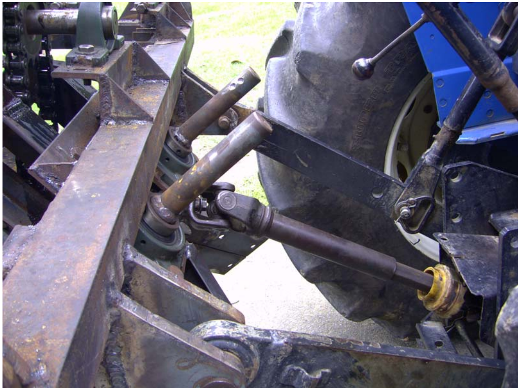
รูปที่ 4.7 กลไกการขับเคลื่อนทั้งหมดได้รับกำลังจากเพลลา PTO ของรถแทรกเตอร์
