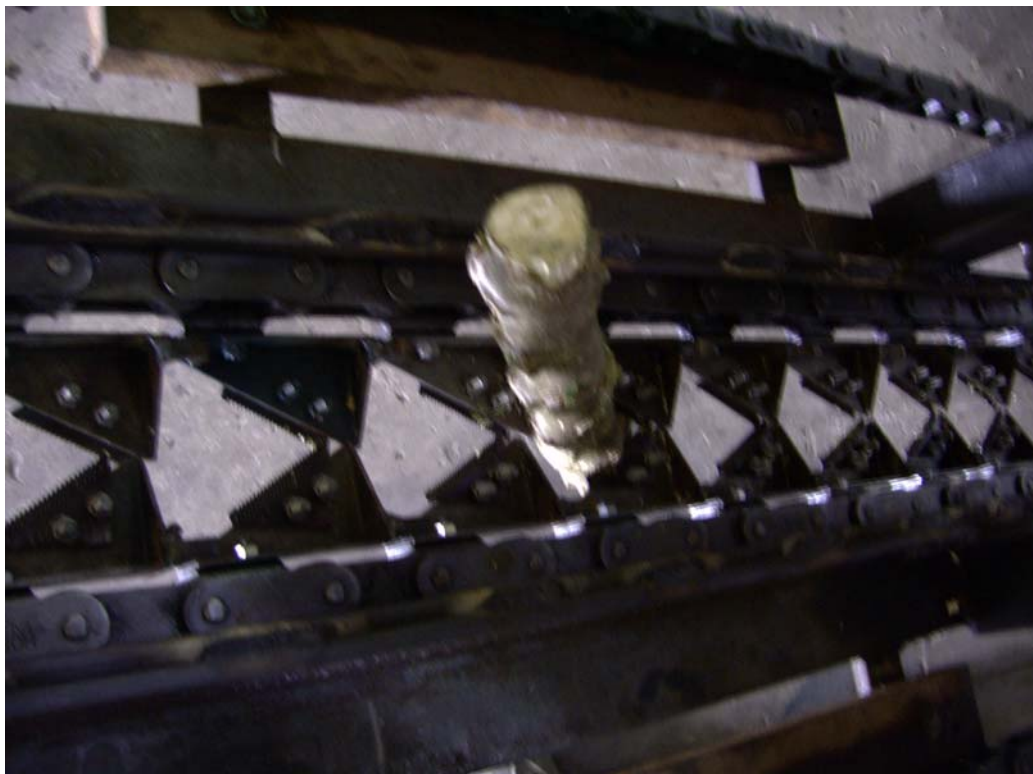
รูปที่ 4.8 ความเร็วเชิงเส้นของโซ่ลำเลียงเท่ากับ 0.58 เมตร / วินาที
