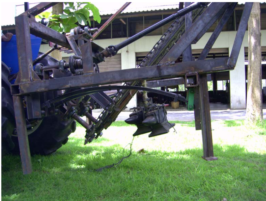
รูปที่ 4.10 ภาพครีปดึงต้นมันสำปะหลังสามารถดึงน้ำหนักได้สูงสุด 110 กก. ได้
