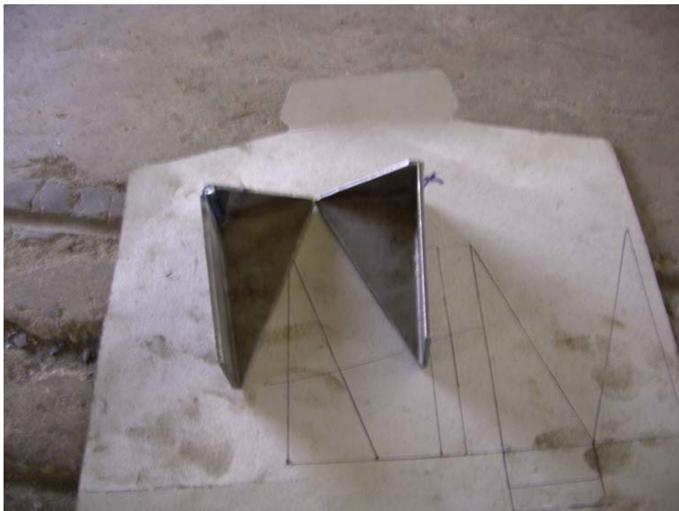
รูปที่ 3.16 การออกแบบครีบก้นเหล็กสำหรับใช้ดึงต้นมันสำปะหลัง
