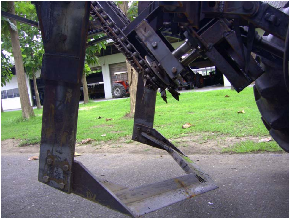
รูปที่ 4.3 หัวชะดินมีหน้ากว้างการขุดชะดินเท่ากับ 80 ซม.
