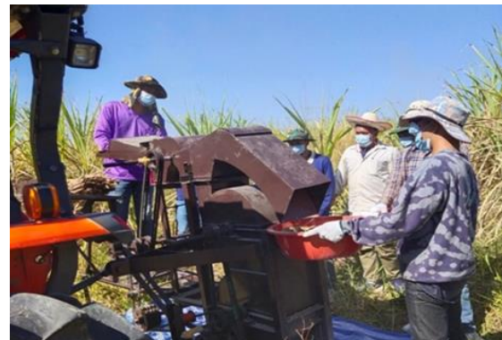
ภาพที่ 6 การทดสอบการทำงานของเครื่องสับย่อยใบอ้อย
