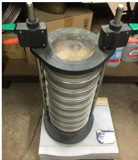
ภาพที่ 7 การทดสอบหาขนาดอนุภาคใบอ้อยหลังสับย่อย
