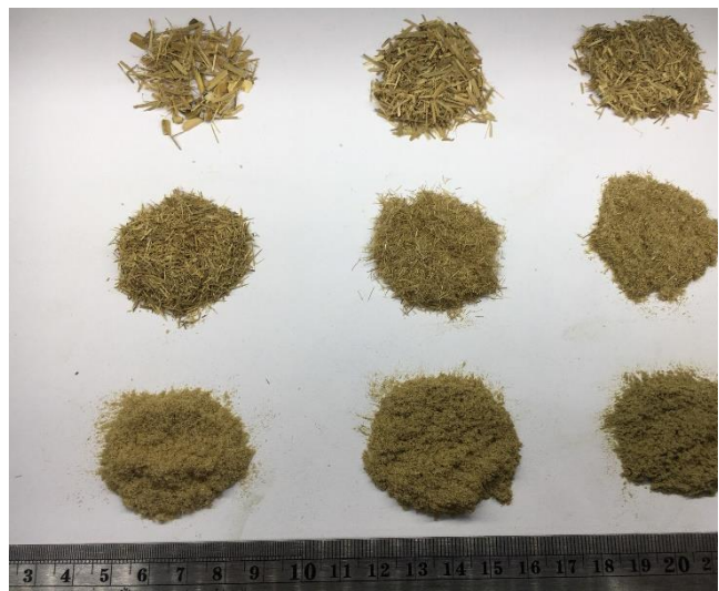
ภาพที่ 7 การทดสอบหาขนาดอนุภาคใบอ้อยหลังสับย่อย
