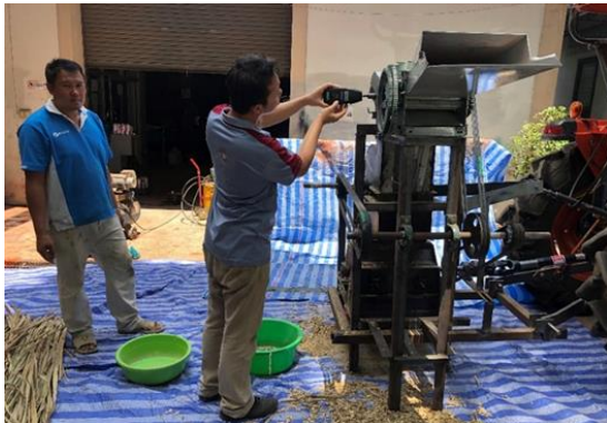
ภาพที่ 6 การทดสอบการทำงานของเครื่องสับย่อยใบอ้อย
