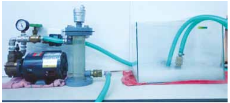
เครื่องต้นแบบล้างผลไม้ตัดแต่งพร้อมบริโภคร่วมกับน้ำอิเล็กโทรไลต์แบบฟองไมโคร
