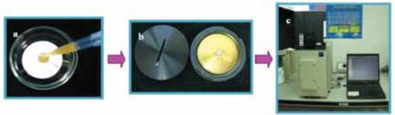
ภาพที่ 5 การเตรียมตัวอย่างโดยหยดน้ำคั้นผลสัมฤทธิ์ผสมสารมาตรฐานสารกำจัดศัตรูพืช (a) ไล้ความชื้น นำกระดาษกรอง บรรจุลงในเซลล์บรรจุตัวอย่าง ที่มีแผ่นทองคำสะท้อนแสง (b) แล้วนำไปวัดสเปกตรัมด้วยเครื่อง NIRSystem 6500 ในช่วงความยาวคลื่น 400-2500 นาโนเมตร (c)
