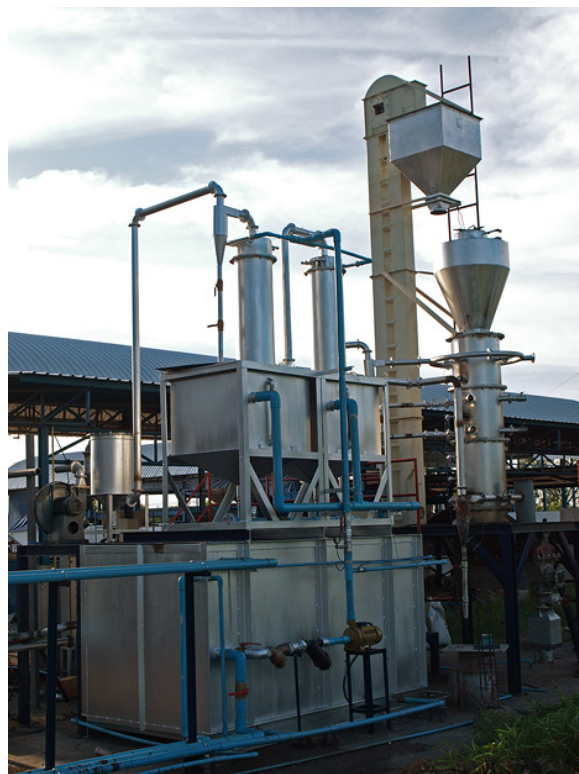
รูปที่ 3-10 ลักษณะเตาผลิตแก๊สเชื้อเพลิง (Gasifier)
