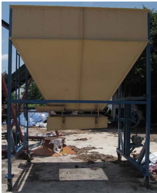
รูปที่ 3-4 ลักษณะถังพักที่ได้ทำการออกแบบและก่อสร้าง
