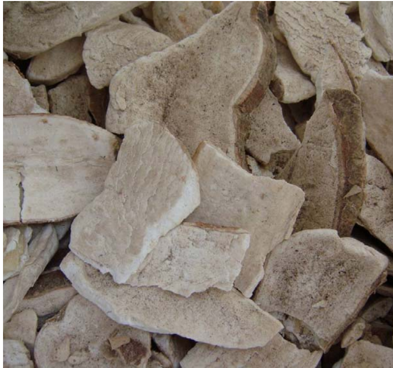
รูปที่ 4-30 ลักษณะของมันเส้นแห้งที่ได้จากการอบแห้งด้วยเครื่องอบแห้งโรตารีต้นแบบ
