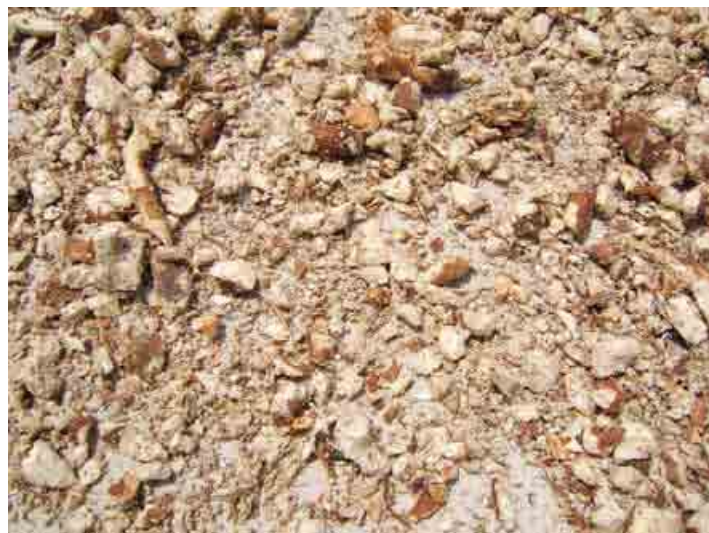
รูปที่ 3-7 ลักษณะมันเส้นที่ได้จากเครื่องตัดหัวมันแบบเจาะรู
