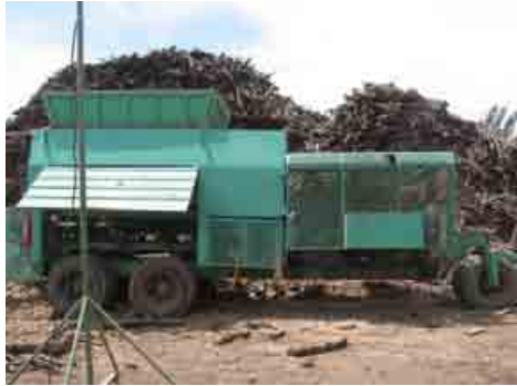
รูปที่ 2-9 เครื่องเคาะ (Shredder) กำลังการผลิต 13 ตัน/ชั่วโมง ต้นกำลังเครื่องยนต์ 400 HP
