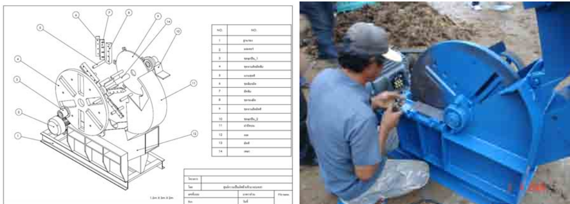
รูปที่ 4-39 เครื่องสับเหง้ามันสำปะหลังแบบใช้มอเตอร์เป็นต้นกำลัง
