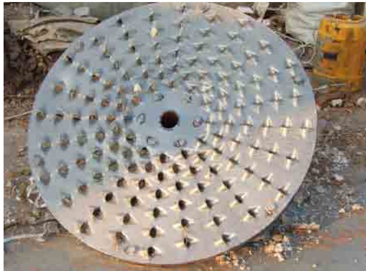
รูปที่ 3-6 ลักษณะงานสับของเครื่องตัดหัวมันแบบจานรู
