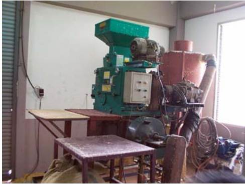
ภาพที่ 8 เครื่องกะเทาะข้าวเปลือกแบบลูกยาง
