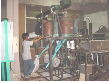
ภาพที่ 1 ชุดทดสอบการขัดข้าวแบบกรวยหินแกนตั้ง
