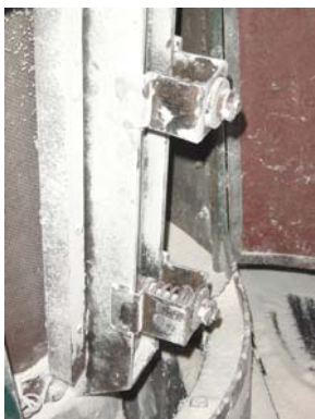
ภาพที่ 6 ชุดปรับแต่งยางขัดขาวแบบมีสปริง
